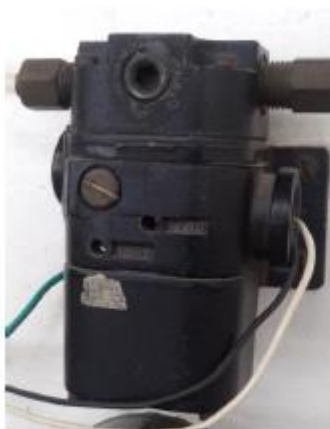
Figura 5. Convertidor de corriente a presión (I/P) marca Moore.
